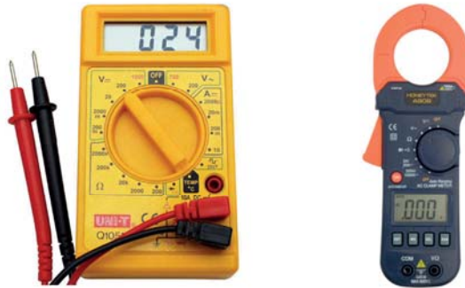
Bild 27. Spänningen kan mätas upp med en multimeter om man vil veta om den avviker från 400 V. Strömmen mäts med en tångamperemeter, tången placeras över den fasledare man vill mäta på. Lämpligen tar man medeltalet från tre fasledare och använder det i formeln för effektberäkning.
