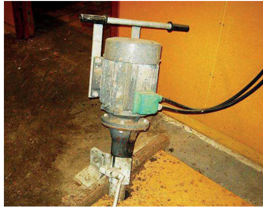
Bild 6. Pumpen i pumpbrunnen bör vara eldriven. Att pumpa med traktor innebär högre energianvändning. Det kan också behövas en eldriven omrörare som kompletterar pumpen.
