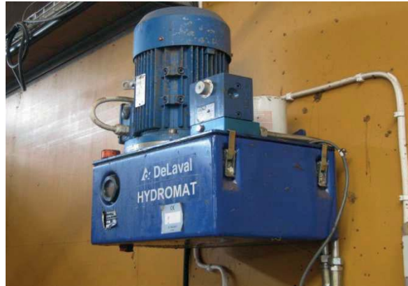
Bild 3. Skrapor på gångar och under spalt kan drivas med linspel eller hydrauliskt. Linspelen är mindre effektkrävande än den hydrauliska drivningen.
