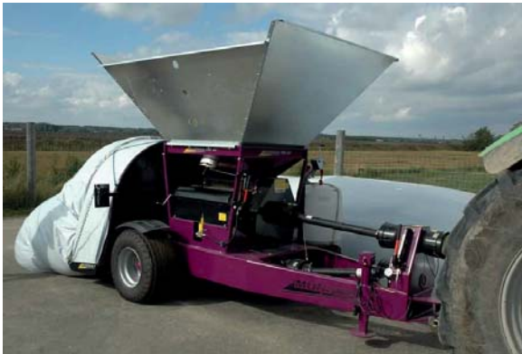
Bild 50. Vid krossensilering används en maskin som både krossar spannmålen och fyller en slang.
