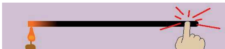
Bild 13. Värme kan t.ex. överföras genom ledning, även kallat värmekonduktion eller värmetransmission.
