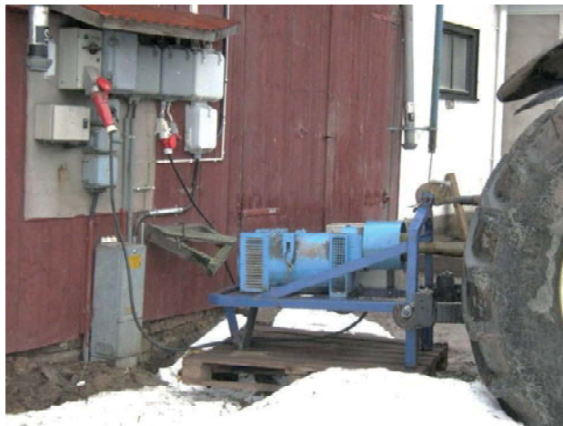
Bild 30. Reservelverkets storlek anges alltid i skenbar effekt, som alltså mäts i VA.
