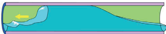
Bild 21. Principbild för proppflöde eller slugflöde (engelska: slug flow), flöde med vattenproppar. Sådant flöde bearbetar röryrtorna bättre. (Källa: DeLaval)
