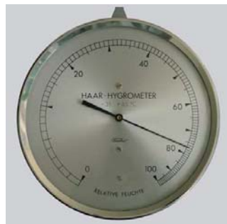
Bild 41. Hårhygrometer. I denna mätare finns hår som drar ihop sig när det torkar och förlängs när det blir fuktigt. Hår är hygroskopiskt. Förändringen i längd förs över till ett visarutslag. Ska kalibreras regelbundet, tex. mot en slungpsykrometer, bild 42. Hårhygrometern har inte så hög precision, men den ger ändå en god uppfattning om förändringar i luftfuktigheten.
