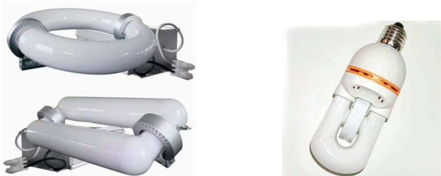
Bild 17. Olika typer av induktionslampor. De två till vänster har lite högre effekt och de har separata driftdon. Den högra lampan har driftdonet integrerat och den kan skruvas i en vanlig sockel E 27. På bilderna ser man också magnetspolarna som små cylindrar. (Källa: siwinlamps.com och www.duxlite.com )
