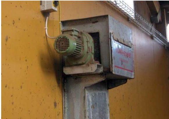
Bild 3. Skrapor på gångar och under spalt kan drivas med linspel eller hydrauliskt. Linspelen är mindre effektkrävande än den hydrauliska drivningen.
