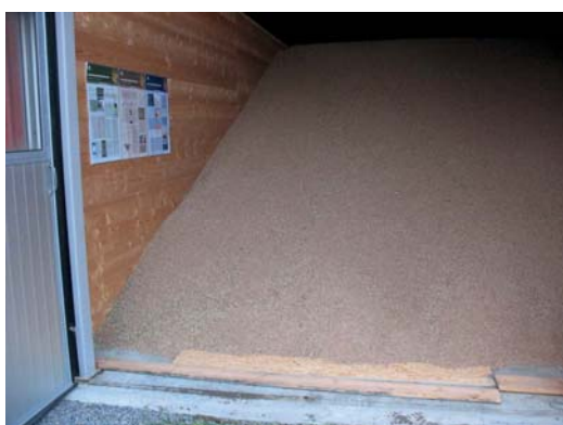
Bild 33. Östgötatorken är en körbar plantork, som kan dimensioneras för torkning av spannmål, hö, flis m.m. I vänstra bilden lagras färdigtorkad spannmål (torkning görs med lägre spannmålshöjd). Den högra bilden visar lagring av fyrkantspressade höbalar. Tillsatsvärme brukar användas.
