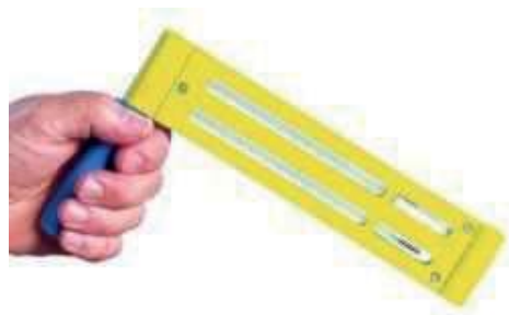
Bild 42. Slungpsykrometer med en torr och en våt termometer. Relativa luftfuktigheten läses av i en tabell, när man vet "torr" och "våt" temperatur.
