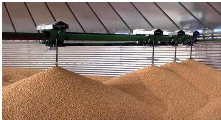
Bild 46. Vertikala, vandrande, skruvar drar upp torrare spannmål för att blanda upp den otorkade.
