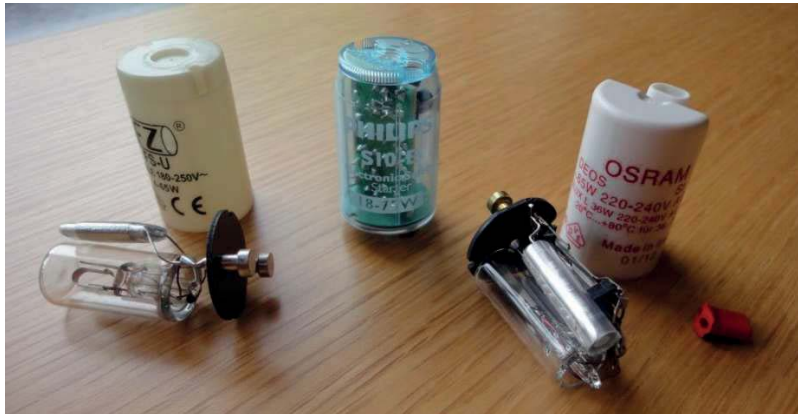
Bild 13. Tre varianter av glimtändare för lysrör. Till vänster en vanlig glimtändare (höljet avtaget och placerat bakom), i mitten en elektronisk säkerhetsglimtändare, till höger en traditionell säkerhetsglimtändare med röd återställningsknapp (isärmoterad).
