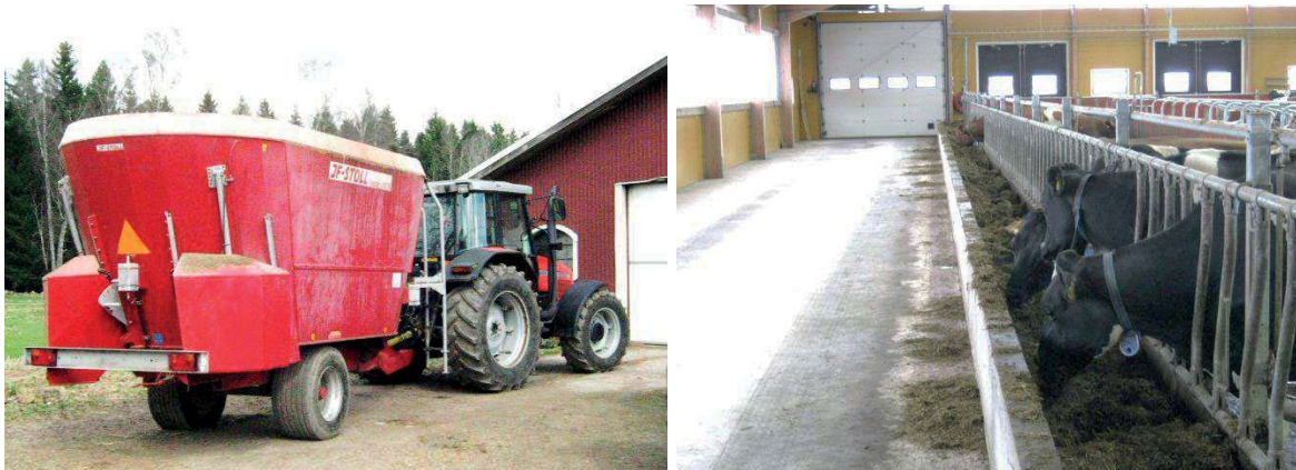
Bild 18. Utfodring med traktordragen mixervagn använder mycket energi. Om det finns förutsättningar väljer man gärna andra system, särskilt vid nybyggnad då man kan spara in på byggnadsytan.
