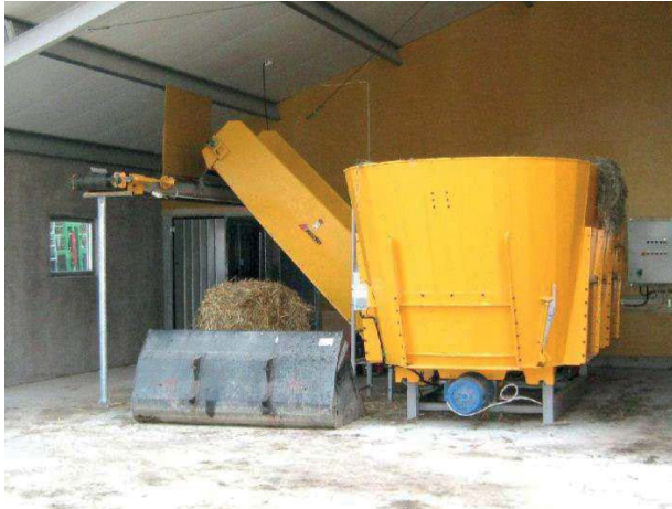
Bild 19. Denna gård har valt en stationär eldriven blandare och en bandfoderfördelare. Som alternativ i utfodring kan man också välja en rälsgående vagn eller en fodertruck.
